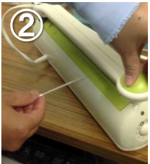
ストロー管の先端をシーリング。
